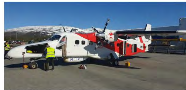
Figur 18. LN-LYR flyet som ble benyttet til datainnhenting før avgang i Tromsø. Instrumentene er plassert i PODen under buken som er merket med NORCE logo.
